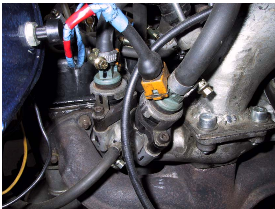
Obr. 5 Detail sekundárných vstříkovacích ventilů
