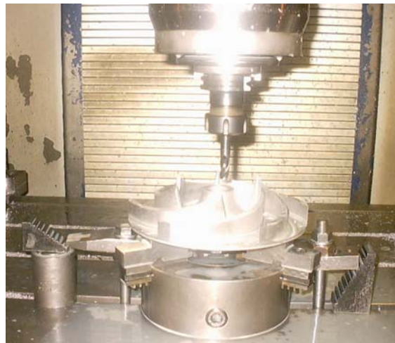
Obr. 19, 20 Obrábění tělesa kola
